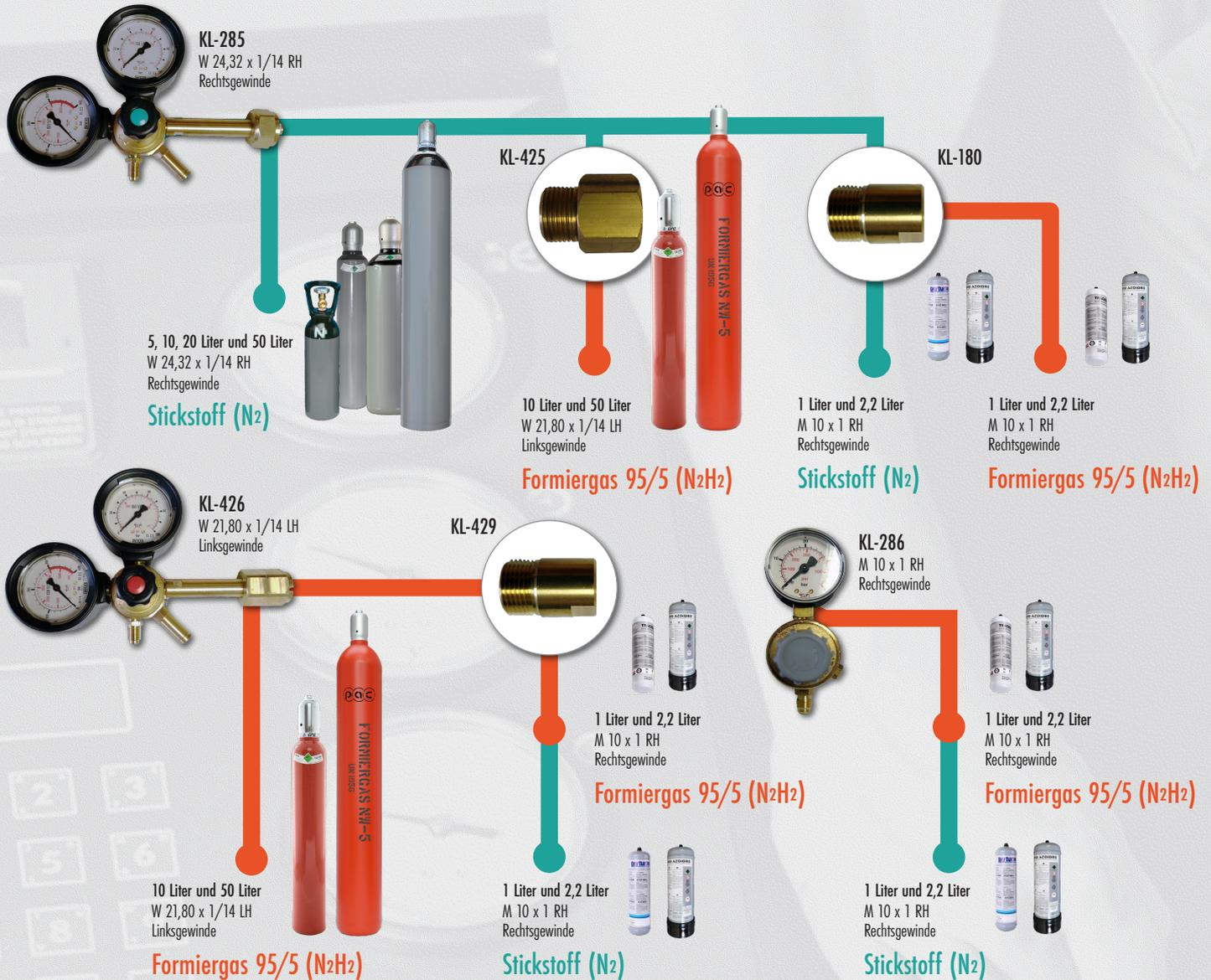
Genormte und verfügbare Flaschengrößen für Deutschland - Stickstoff (N<sub>2</sub>) und Formiergas 95/5 (N<sub>2</sub>H<sub>2</sub>)
