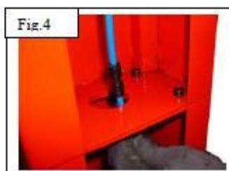
Führen Sie dann die Rohre in die entsprechenden Verschraubungen ein (siehe Abb. 4)
