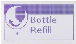
Abbildung 10 – Nachfüllen des internen Tanks
