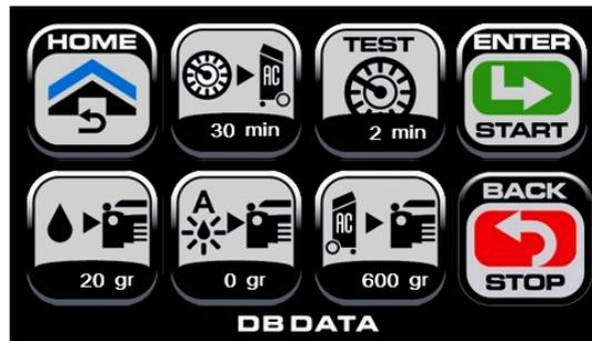
Auf dieser Seite wurden alle Parameter dank der Datenbank bereits automatisch eingestellt. Gegebenenfalls können die Parameter geändert werden. Um die Parameter zu ändern, befolgen Sie die Anweisungen für das automatische Verfahren (Kap. 6.1)
