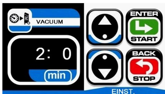
Die Standardzeit ist auf 30 Minuten eingestellt; verwenden Sie die Pfeile UP/DOWN, um sie zu ändern
