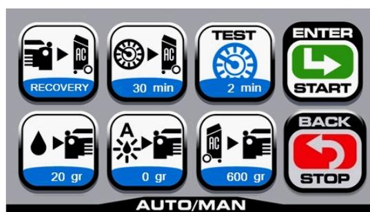
Dieser Bildschirm enthält Standardparameter, die geändert werden können, bevor mit dem automatischen Zyklus fortgefahren wird.
