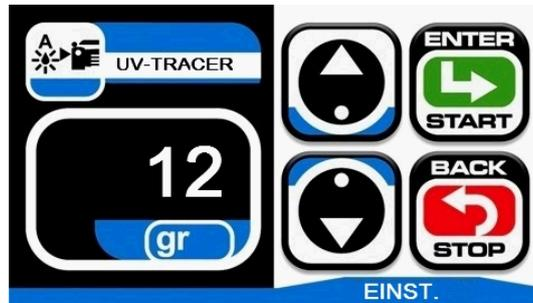
Die Standardzeit ist auf 12 Minuten eingestellt; verwenden Sie die Pfeile UP/DOWN, um sie zu ändern
