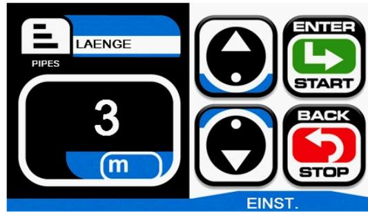
Die Standardlänge ist auf 3 Meter eingestellt; verwenden Sie die Pfeile UP/DOWN, um sie zu ändern
