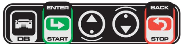
Verwenden Sie den Touchscreen oder die Tastatur (in diesem Fall drücken Sie DIE ENTER/START-TASTE, um die Funktion aufzurufen), um das Symbol des Parameters auszuwählen, den Sie ändern möchten
