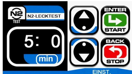
Die Standardzeit ist auf 5 Minuten eingestellt; verwenden Sie die Pfeile UP/DOWN, um sie zu ändern.
