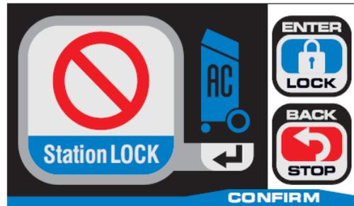
Drücken Sie DIE ENTER-/LOCK-TASTE, um die Station in den Standby-Modus zu versetzen
