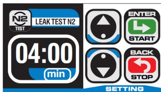
Die Standardzeit ist auf 5 Minuten eingestellt; verwenden Sie die Pfeile UP/DOWN, um sie zu ändern
