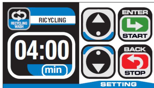
Die Standardzeit ist auf 10 Minuten eingestellt; verwenden Sie die Pfeile UP/DOWN, um sie zu ändern
