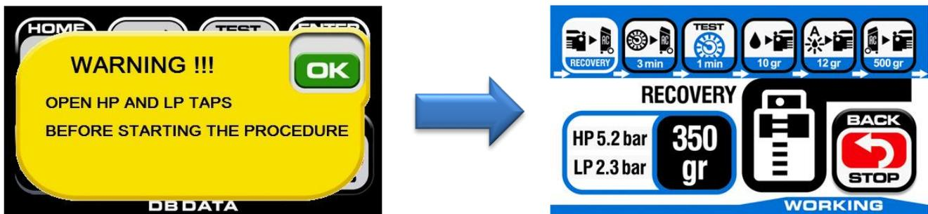
ÖFFNEN Sie die HD- UND ND-HÄHNE UND DRÜCKEN Sie die OK-TASTE, um DEN AUTOMATISCHEN VORGANG FORTZUSETZEN (siehe Abschnitt 6.1 Seite. 17)
