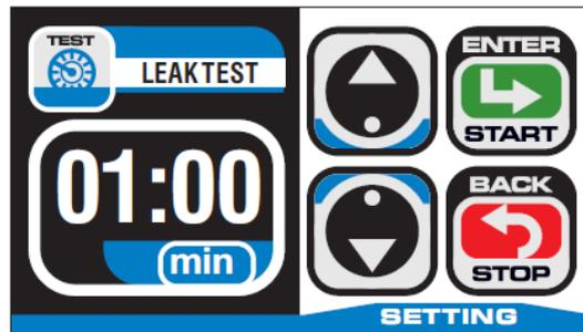
Die Standardzeit ist auf 3 Minuten eingestellt; verwenden Sie die Pfeile UP/DOWN, um sie zu ändern
