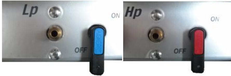
**Figura 9 b- Verbindungen und Ventile ND und HD**
