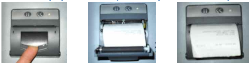
Fig. 8 - Procedimiento para el cambio de papel
