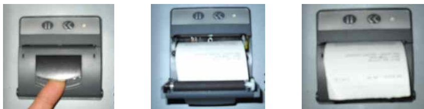
Fig. 8 – Procédures pour le remplacement du papier
