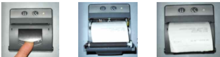
Figura 8 - Operazioni per la sostituzione della carta
